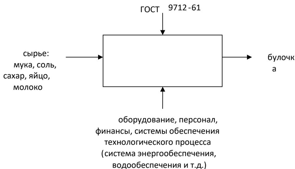
Рисунок 8. Элементарная схема производства булочки
